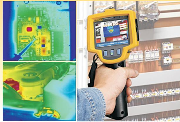
Termokamera pracuje v infračervenom spektri žiarenia, ktoré vyžarujú skúmané objekty. Toto žiarenie termovízna kamera sústreduje na polovodičový detektor, ktorý ho mení na elektrický signál.
