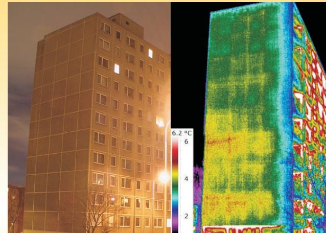
Termografická metóda má široké použitie. Zlé izolácie a rôzne teplotné anomálie môžu mať za následok okrem zvýšenej energetickej náročnosti aj vznik rôznych funkčných porúch v častiach stavebnej konštrukcie.
